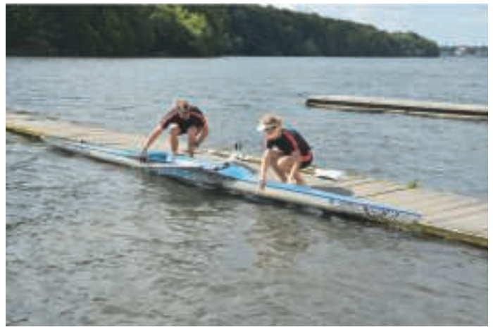
Olympiasieger Marcel Hacker testet das Papier-Boot. Es besteht aus einem Papier-Epoxy- Komposit, und wurde für die „Ideen Expo 2015“ von einem Konsortium aus Verbänden, Industrie, der BBG Bootsbau Berlin und der TU Darmstadt hergestellt.
